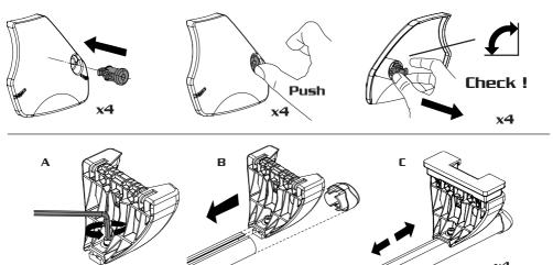
in caso di piedi pre montati saltare le fasi A e B - in case of pre-assembled feet skip phases A and B - en cas de pieds pré-montés, sauter les phases A et B - im Falle vormontierter Füße die Phasen A und B überspringen - En el caso de los pies pre-montados saltan las fases A y B
