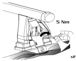
FR: Serrer alternativement chaque côtè ES: Apriete los tornillos alternativamente DE: Die Schrauben abwechselnd anziehen EN: Tighten alternately IT: Serrare in modo alternato
