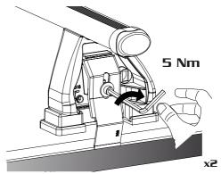
FR: Serrer alternativement chaque côtè ES: Apriete los tornillos alternativamente DE: Die Schrauben abwechselnd anziehen
