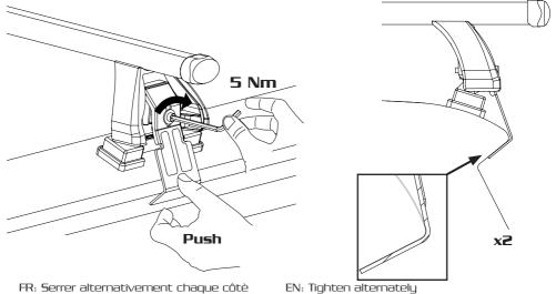
FR: Serrer alternativement chaque côtè ES: Apriete los tornillos alternativamente DE: Die Schrauben abwechselnd anziehen
