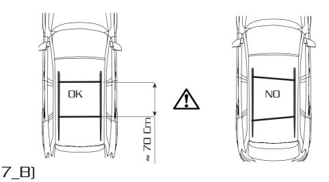
EN: Vehicles with fix point F: Voiture avec prédisposition d'origine IT: Vetture con punti di fissaggio - D: Fahrzeuge mit Original-Befestigungspunkten
