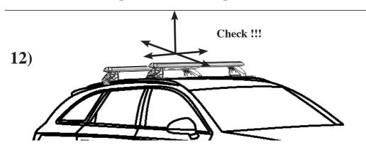
ES :Antes de iniciar el trayecto, verificar que las barras y la carga esten bien sujetas, si fuera necesario, repetir el montaje o comprobarlo en un distribuidor autorizado.EN: Before starting, ALWAYS check that bars and cargo are correctly tightened, if necessa¬ry, repeat assembly or check it with an authorized dealer.
