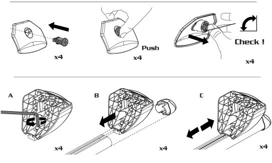
in caso di piedi pre montati saltare le fasi A e B - in case of pre-assembled feet skip phases A and B en cas de pieds pré-montés, sauter les phases A et B - im Falle vormontierter Füße die Phasen A und B überspringen - En el caso de los pies pre-montados saltan las fases A y B
