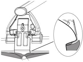
FR: Serrer alternativement chaque côtè ES: Apriete los tomillos alternativamente DE: Die Schrauben abwechselnd anziehen EN: Tighten alternately IT: Serrare in modo alternato
