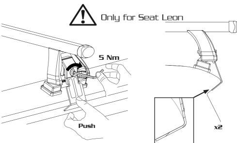
FR: Serrer alternativement chaque côtè ES: Apriete los tornillos alternativamente DE: Die Schrauben abwechselnd anziehen EN: Tight<del>en alternately</del> IT: Serrare in modo alternato
