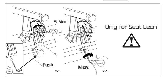
FR: Serrer alternativement chaque côtè ES: Apriete los tomillos alternativamente DE: Die Schrauben abwechselnd anziehen EN: Tighten alternately
