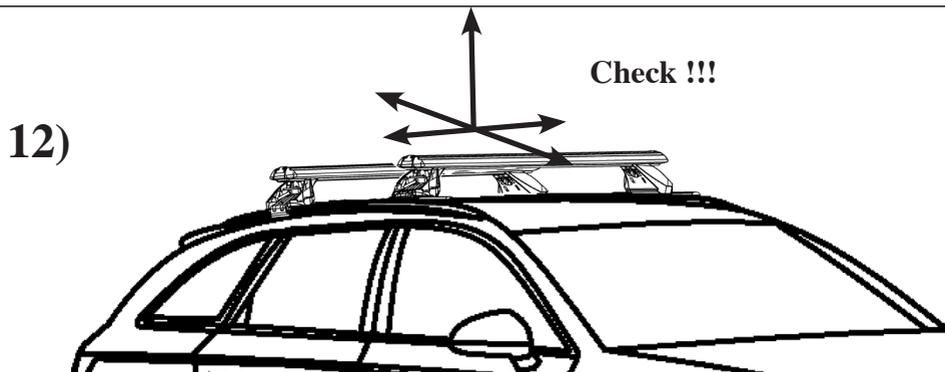
ES :Antes de iniciar el trayecto, verificar que las barras y la carga esten bien sujetas, si fuera necesario, repetir el montaje o comprobarlo en un distribuidor autorizado. EN: Before starting, ALWAYS check that bars and cargo are correctly tightened, if necessary, repeat assembly or check it with an authorized dealer.
