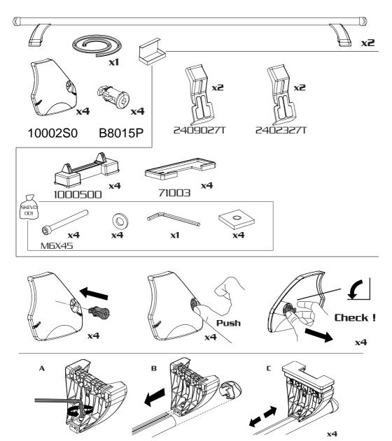
in caso di piedi pre montati saltare le fasi A e B - in case of pre-assembled feet skip phases A and B en cas de pieds pré-montés, sauter les phases A et B - im Falle vormontierter Füße die Phasen A und B überspringen - En el caso de los pies pre-montados saltan las fases A y B
