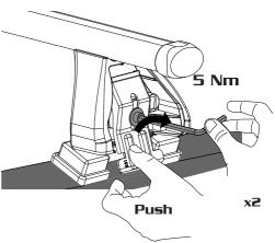
FR: Serrer alternativement chaque côtè ES: Apriete los tornillos alternativamente DE: Die Schrauben abwechselnd anziehen EN: Tighten alternately
