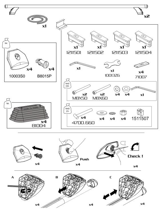
in caso di piedi pre montati saltare le fasi A e B - in case of pre-assembled feet skip phases A and B en cas de pieds pré-montés, sauter les phases A et B - im Falle vormontierter Füße die Phasen A und B überspringen - En el caso de los pies pre-montados saltan las fases A y B
