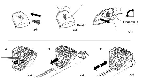
in caso di piedi pre montati saltare le fasi A e B - in case of pre-assembled feet skip phases A and B en cas de pieds pré-montés, sauter les phases A et B - im Falle vormontierter Füße die Phasen A und B überspringen - En el caso de los pies pre-montados saltan las fases A y B
