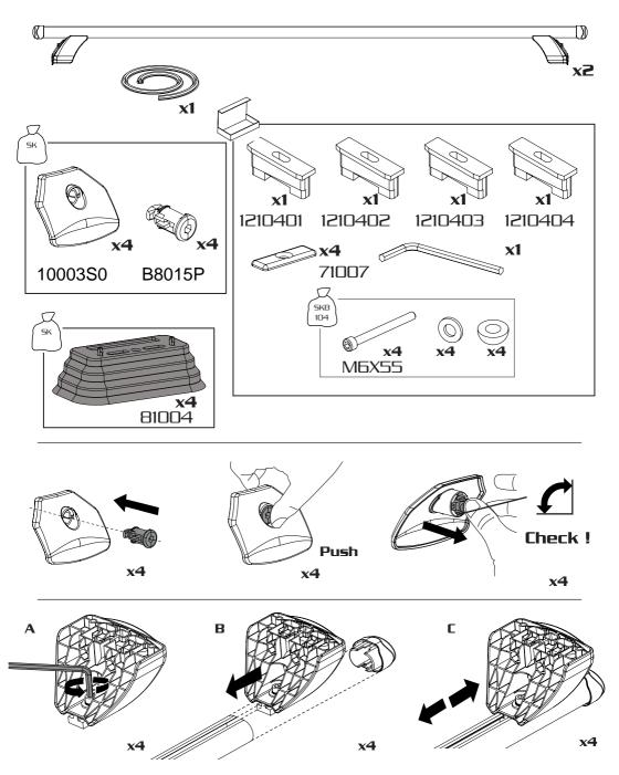
in caso di piedi pre montati saltare le fasi A e B - in case of pre-assembled feet skip phases A and B - en cas de pieds pré-montés, sauter les phases A et B - im Falle vormontierter Füße die Phasen A und B überspringen - En el caso de los pies pre-montados saltan las fases A y B
